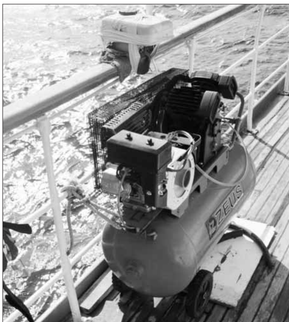
Εικ. 9. Πρόχειρη επισκευή αεροσυμπεστή επί του σκάφους.
