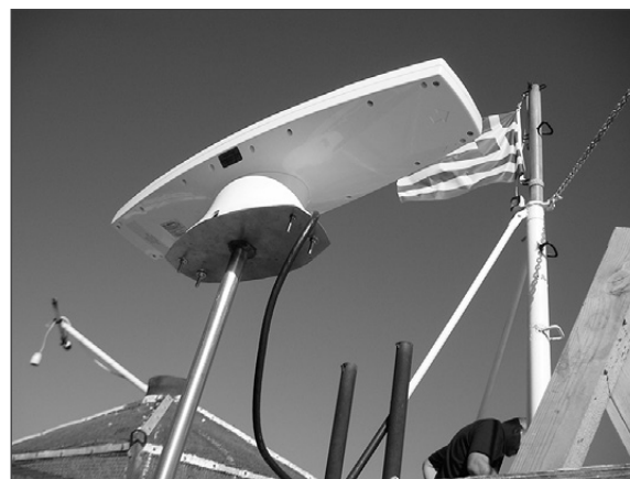
Εικ. 3. Η κεραία του GPS Hemisphere προσαρμοσμένη στο σκάφος έρευνας.
