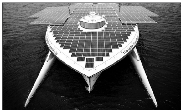
Εικ. 13. Το ηλιακό σκάφος τύπου catamaran “Turanor Planet Solar”.
