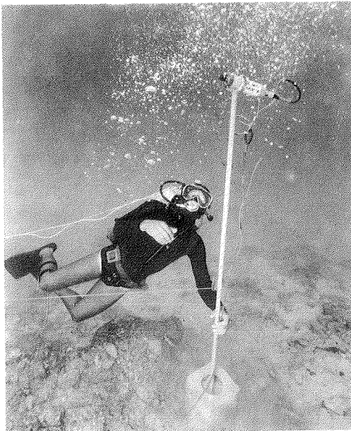
Εικ. 1. Τοποθέτηση πομποδέκτη SHARPS στο βυθό.
